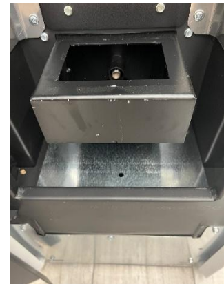
Figura 25 - Entfernen des Brenntiegels und der Aschenlade.
