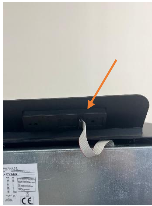
Abbildung 18 - Entfernen der Displaygehäuseschraube
