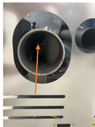
Abbildung 27 - Reinigung der Rauchabzugsöffnung
