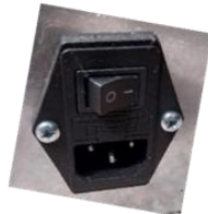
Abbildung 5 – Steckdose mit Hauptschalter
