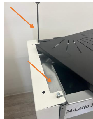
Abbildung 21 – Entfernung der Seitenwand durch Ziehen nach oben
