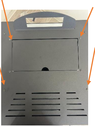
Abbildung 20a – Entfernen des Deckels
