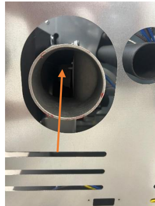
Abbildung 27 - Reinigung der Rauchabzugsöffnung
