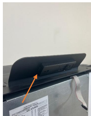
Abbildung 19 - Entfernen des Displays
