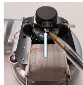
Abbildung 30 – Reinigung der Encoder-Verbindung – Schritt 2
