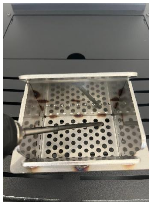
Abbildung 14 – Reinigen der Brennschale
