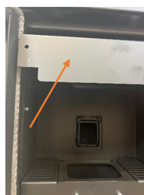
Abbildung 23 - Entfernung des Flammenbrechers
