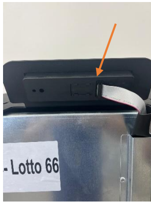
Abbildung 17 - Trennen des Flachbandkabels
