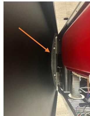
Abbildung 21 - Entfernung der Seitenwand durch Hochziehen
