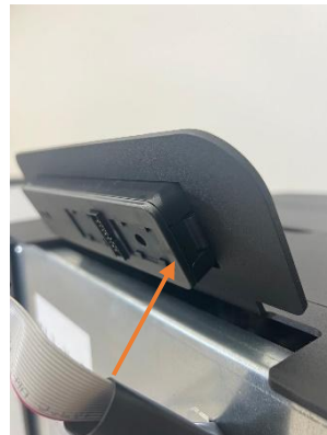
Abbildung 18 - Entfernung des Displays (seitliche Laschen des Displays drücken)
