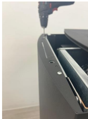
Abbildung 20 - Entfernung der seitlichen Schrauben
