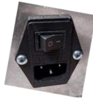
Abbildung 5 – Steckdose mit Hauptschalter
