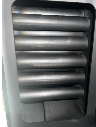
Abbildung 28 - Abgasführung in den Wärmetauschern (Ansicht ohne Flammenbrecher)
