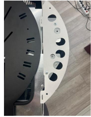
Abbildung 22 – Entfernung der Seitenwand durch Ziehen nach oben
