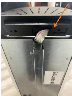
Abbildung 18 - Trennen des Flachbandkabels
