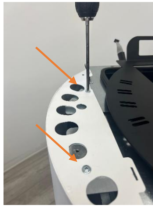
Abbildung 21 - Entfernung der seitlichen Schrauben
