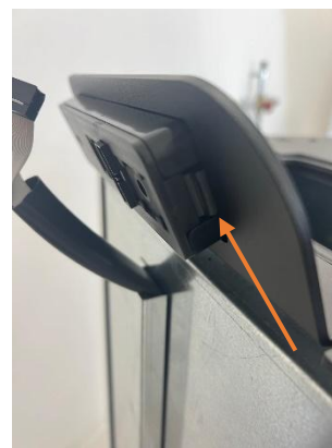
Abbildung 19 - Entfernung des Displays (seitliche Laschen des Displays drücken)
