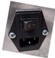
Abbildung 5 – Steckdose mit Hauptschalter
