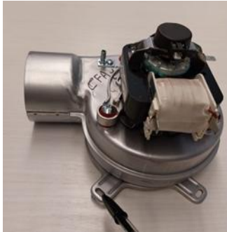
Abbildung 33 - Reinigen des Rauchabzugs
